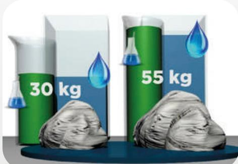
**Charge proportionnelle:** Le dosage de produits chimiques et de l'eau est réglé de manière automatique en fonction de la charge, laquelle peut varier entre 30 et 55 kg.
