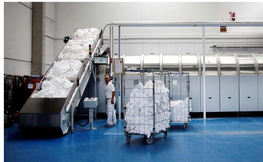
Sistema de túnel de lavado
