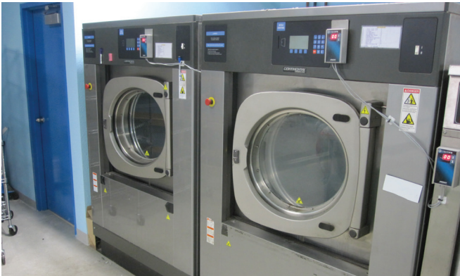
Krazee Klean dispone de 2 lavacentrifugas de la serie H de 40 kg de capacidad.
