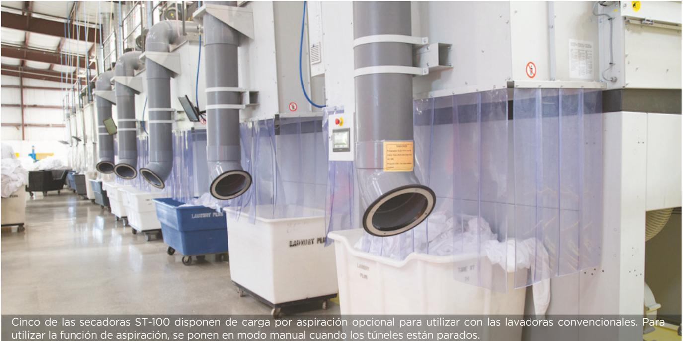
Cinco de las secadoras ST-100 disponen de carga por aspiración opcional para utilizar con las lavadoras convencionales. Para utilizar la función de aspiración, se ponen en modo manual cuando los túneles están parados.
