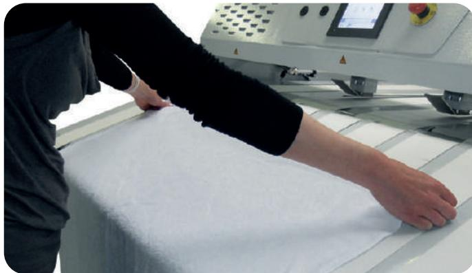
Desta forma, garante-se uma alimentação de alta qualidade. A mesa de alimentação é totalmente ergonômica e ajustável em altura. Fatores como a segurança e a ergonomia são omnipresentes do dobrador FTMAXI.
